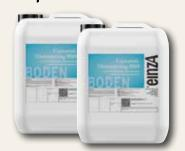
Haft- und Grundierdispersion zur Vorbereitung des Untergrundes nach DIN 18365. Geeignet auf saugfähigen und nicht saugfähigen Untergründen wie Estrichen, Rohbetondecken, Natur- und Kunststein, keramischen Fliesen und Platten u.a.m., vor dem Egalisieren und Spachteln. Als Haftbrücke bei Altbausanierungsmaβnahmen und im Sportstättenbau, u.a. auf vorhandenen Spachtel- und Ausgleichsmassenschichten
