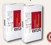
Holzbodenausgleich 5006 ist eine elastische, faserverstärkte Ausgleichsmasse und dient zum Spachteln, Ausgleichen und Nivellieren von Holzdielenböden, Holzpreßspanplatten (V 100) und Trockenausbauelementen im Innenbereich. Die Masse ist pumpbar und kann in einem Arbeitsgang in Schichtstärken zwischen 3 und 15 mm eingebracht werden.
