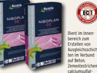
gebundenen Estrichen sowie auf Altuntergründen mit alten wasserfesten Klehstoffresten oder keramischen Belägen. In Schichtstärken von 5 - 40 mm in einem Arbeitsgang einsetz bar. Auch für den Einsatz unter Parkettbelägen geeignet. Verbrauch: ca. 1,7 kg/m² je mm Schichtdicke
