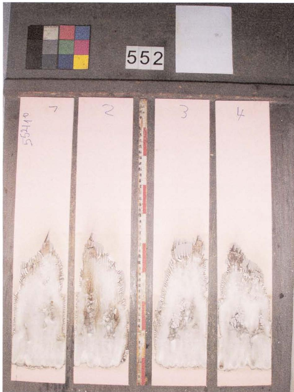
Bild 1: Aussehen des Probekörpers B nach dem Brandschachtversuch
